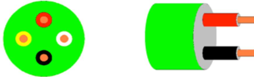
*Disponibile nella versione a 1 o 2 coppie di conduttori twistati, il cavo è schermato secondo norme fino a 440V , perciò è possibile installarlo anche in canaline affianco a cavi di potenza.*
